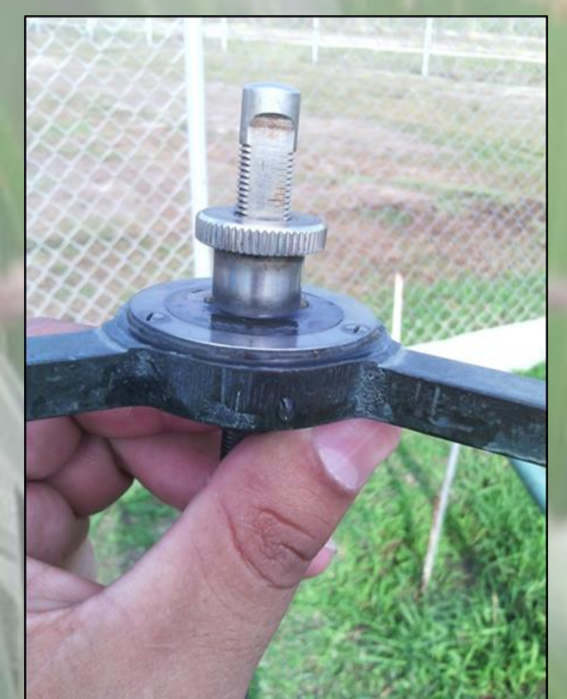
Imagen 2. cálculo de evaporación con ayuda de tornillo micrométrico en tina con producto
