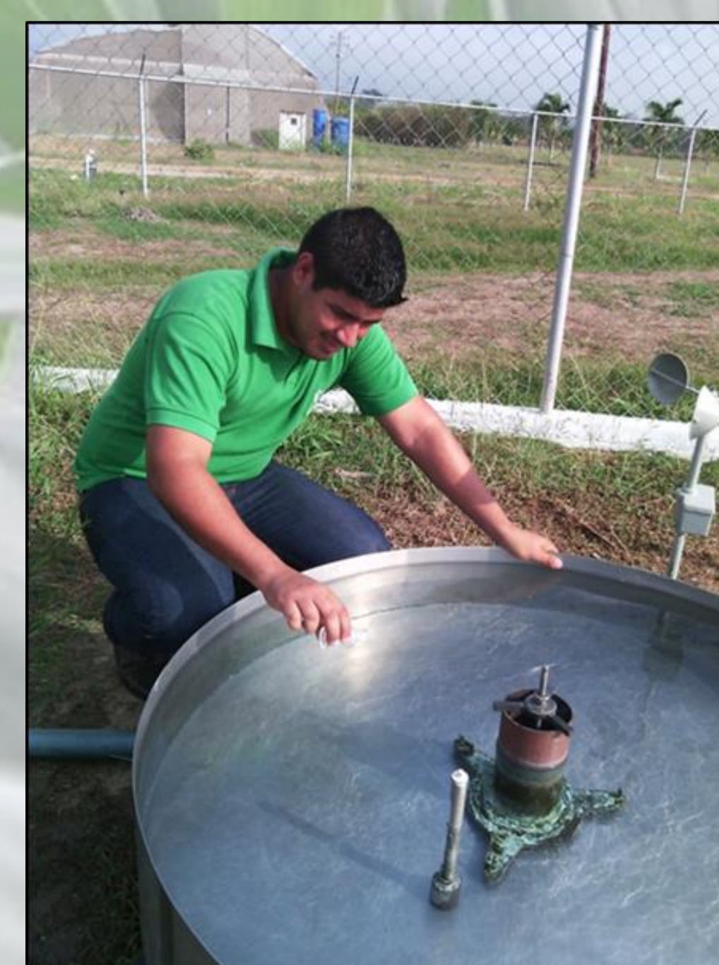
Imagen 1. Aplicación del producto AQUATAIN AMF® en tina de evaporación tipo A
